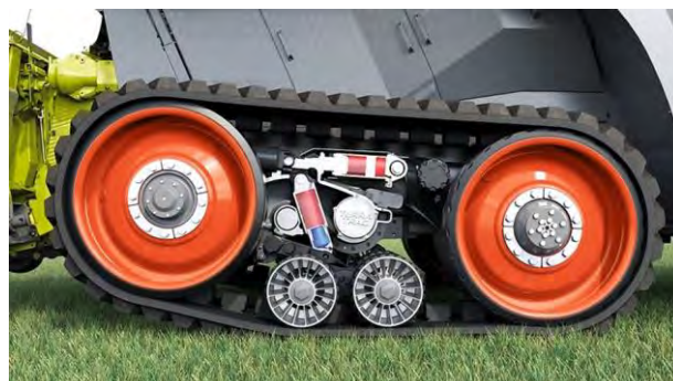
schematische Darstellung der Kettenspannelemente (Claas KGaA mbH, 2022)
